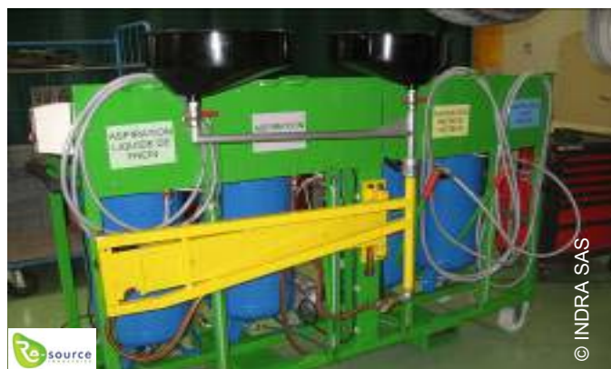
↑ Station mobile de dépollution permettant la dépollution des huiles (moteur, boîte, direction assistée), du liquide de frein, du liquide de lave-glace, du liquide de refroidissement moteur
