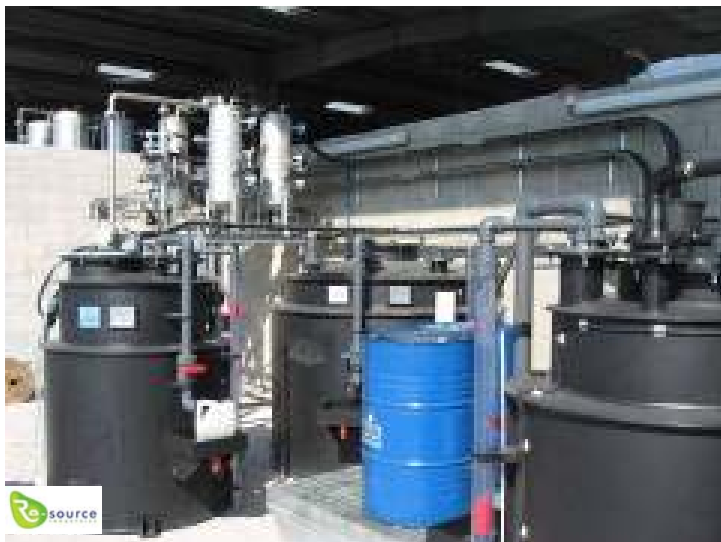
↑ Centrale d'aspiration par le vide pour dépollution des fluides contenus dans les véhicules
