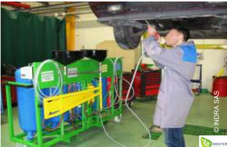
↑ Station mobile de dépollution en utilisation
